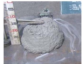
写真-2 荷卸し時のコンクリート性状
