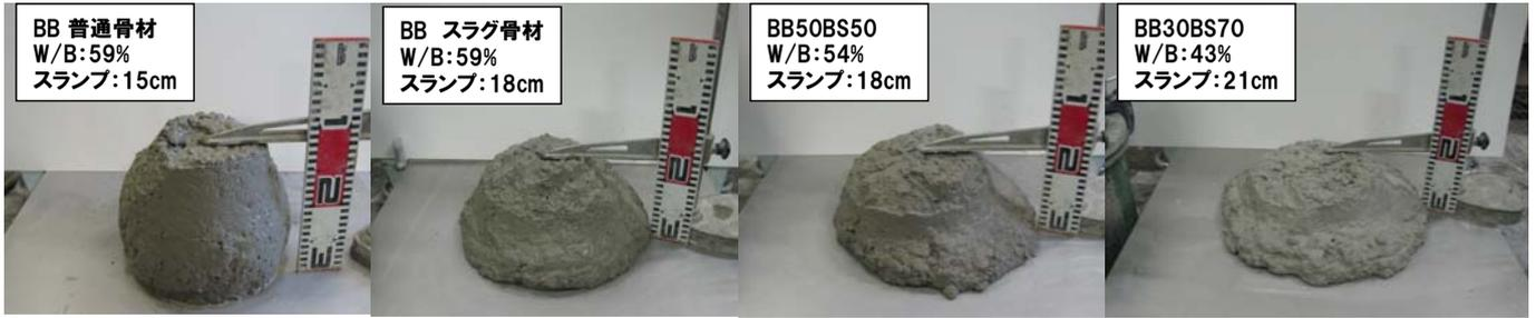
図-1 各種コンクリートのスランプ試験状況
