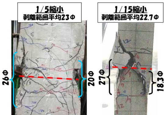
写真-1 Py を下回ったときの損傷状況
