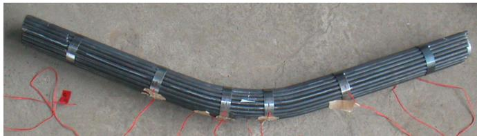
図4 曲げ載荷試験後の状況
