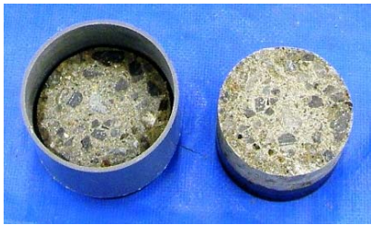
写真3 所定の負荷後の引張試験後の供試体（接着剤無塗布）
