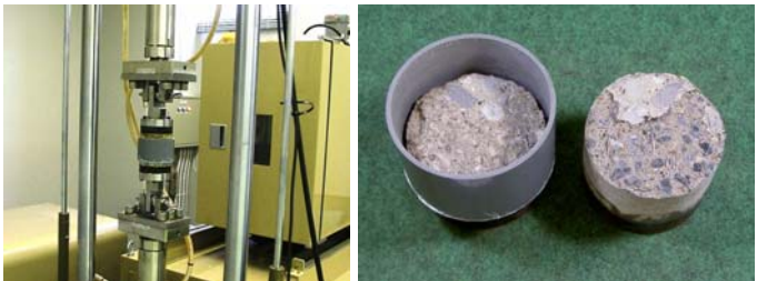
写真1 水浸引張疲労試験状況 写真2 所定の負荷後の引張試験後の供試体例（接着剤塗布）
