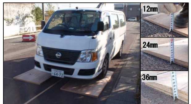
写真-1 測定および段差の設定の状況
