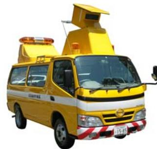
写真-1 路面計測車
