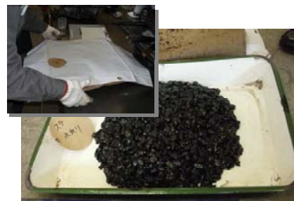
写真-2 混合物の養生状況
