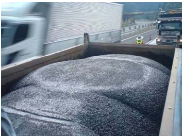
写真-1 運搬中に発生したダレ現象
