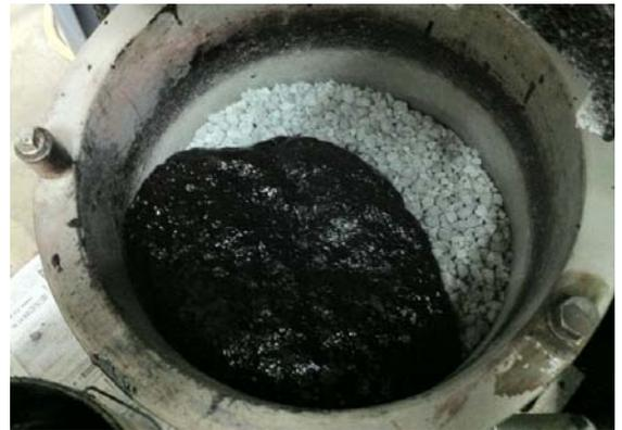
写真-1 フォームドアスファルト投入直後の様子<sup>2)</sup>
