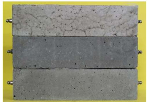
写真-2 ひび割れ発生状況の比較（上から OP、GP-1、GP-2）
