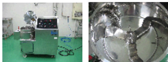
写真-1 使用した攪拌造粒機(左:装置全体, 右:内部)
