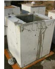
写真-3 桁形試験体の打設風景 写真-4 桁形試験体(FRC-SH 造粒)
