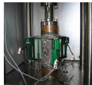
写真-1 pull-push 一軸疲労試験
