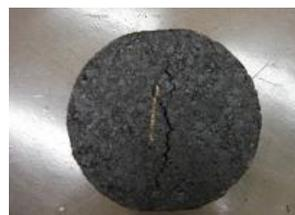
写真-1 試験後のマーシャル供試体
