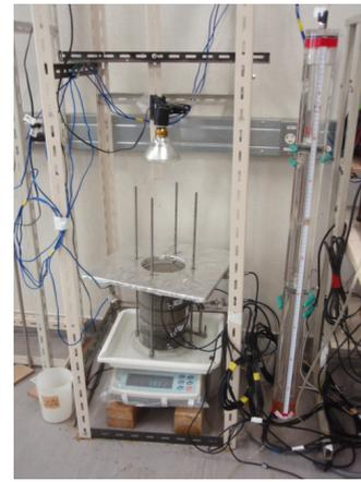
写真 1 吸水・蒸発試験状況
