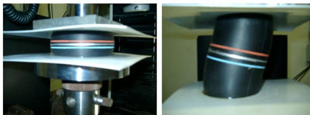
図 1 縦横比が小さい場合の樽状変形及び縦横比が大きい場合の座屈
