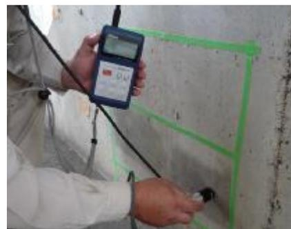
図-1 電気抵抗式水分計
