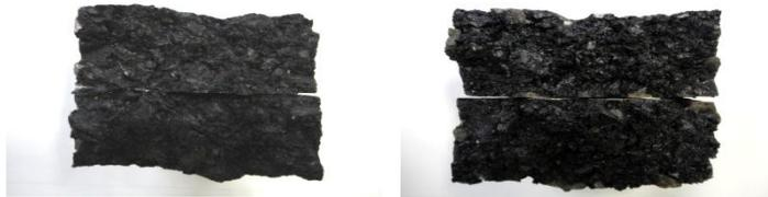
標準圧裂試験後 110°C 30分養生後試験後
