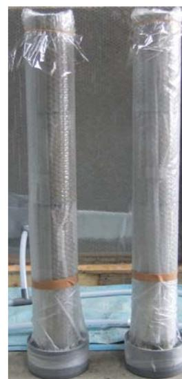
写真-1 浸水養生供試体
