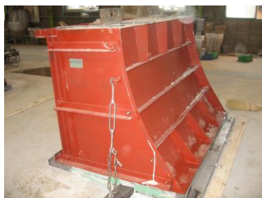
写真-1 型枠を模擬した型枠
