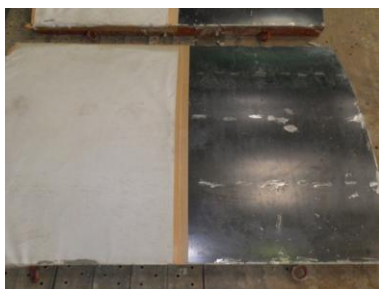
写真-2 透水性シート
