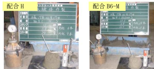
写真 2 フレッシュコンクリート性状 (実験 B)
