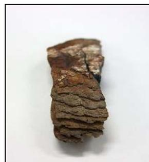
写真-1 層状の腐食生成物の一例
