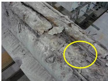
試料A（日本-RC 栈橋桁）
