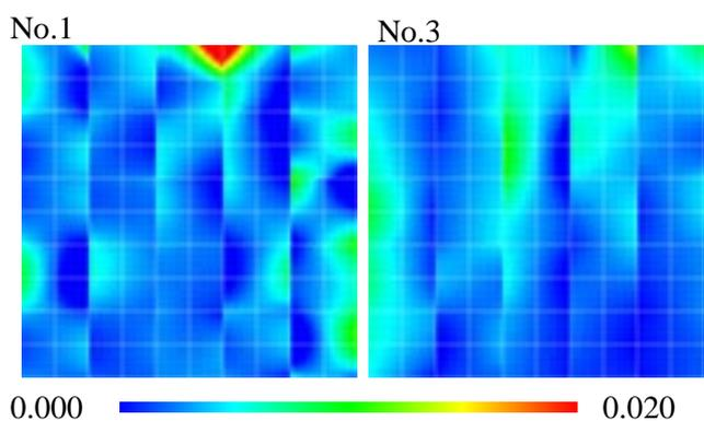
図-6 主引張ひずみ分布 ( $40 \text{ N/mm}^2$  周辺)
