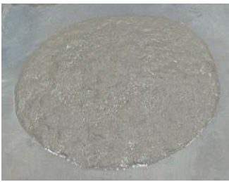
写真－5 スランプフロー試験後の状況
