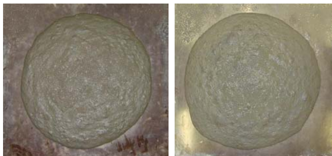
写真-2 スランプフロー試験後のモルタルの状況 左：プラントミキサに鋼繊維を投入した場合 右：アジテータトラックに鋼繊維を投入した場合
