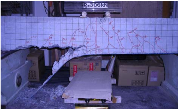
写真-1(b) No. 7 (ウレタン有) 供試体
