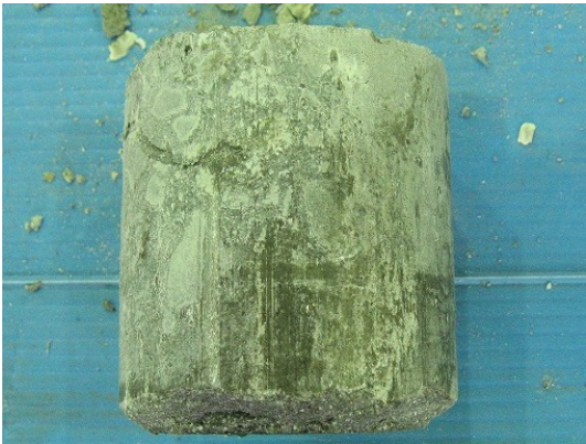
写真-2 破壊状況 (削孔_プライマー処理)
