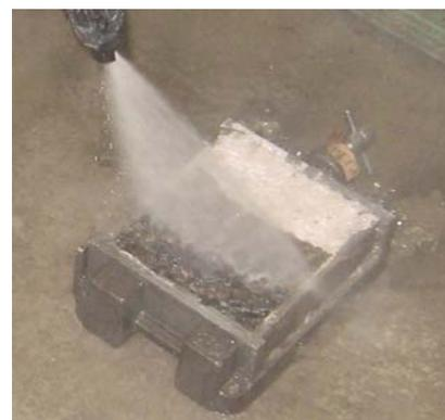
写真-1 高圧水洗浄機による洗出しの状況
