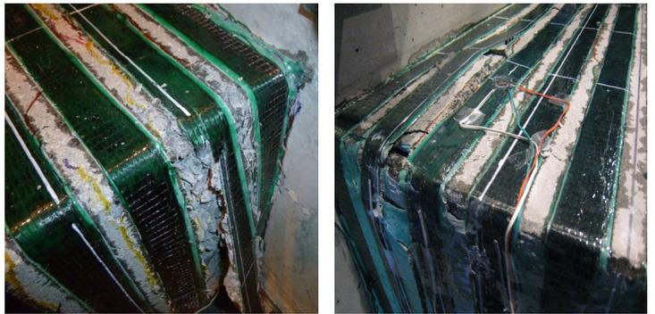
図 - 4 純曲げ時破壊状況: 充実断面 (左図), 中空断面 (右図)
