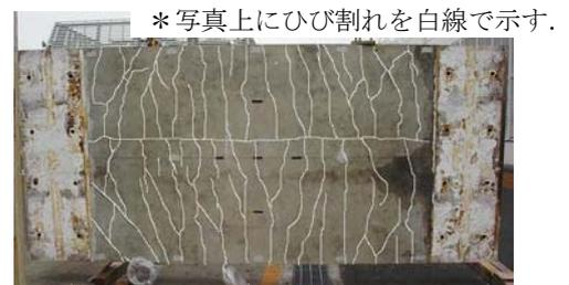
図-6 試験体裏面のひび割れ状況(加熱終了後)
