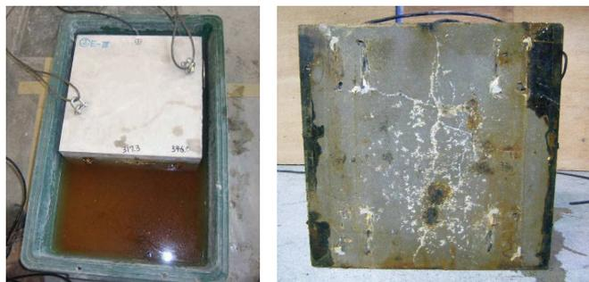
図-2 電気腐食法による作製供試体
