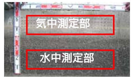
写真3 水路コンクリート測定部
