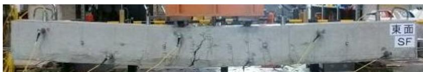
写真-1 荷重载荷後の供試体の損傷状況例
