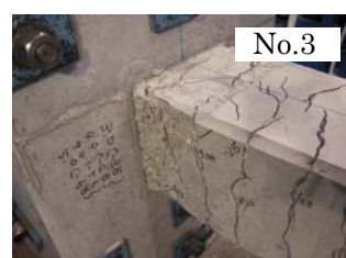
(湿式 PCM 吹付け補強)
