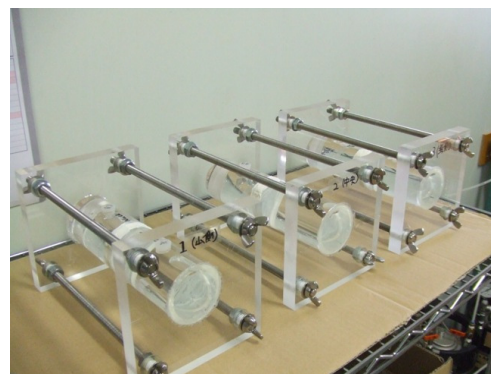
写真-2 遮塩性試験状況
