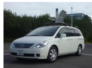
写真-1 T3D モバイル計測システム
