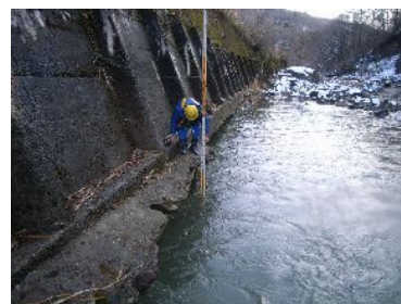
写真-1 河床測定状況
