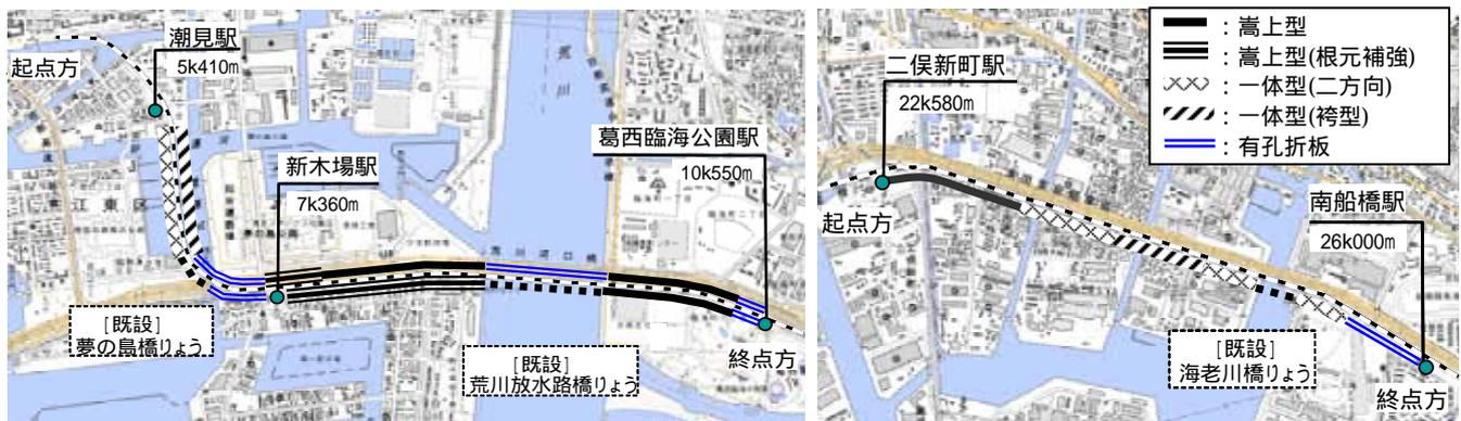
図.4 対策工別の JR 京葉線強風対策計画
