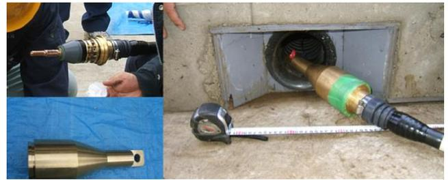
図-4 端子部保護カバーと使用状況
