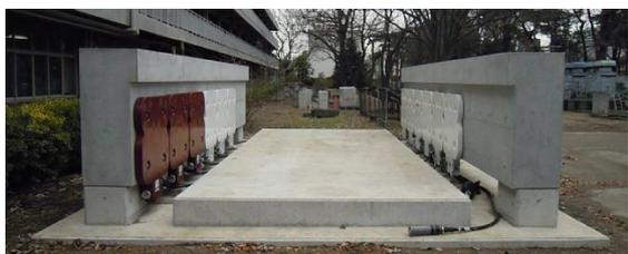
図-2 施工性検証用模擬側壁
