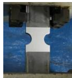
写真-1 引張試験体
