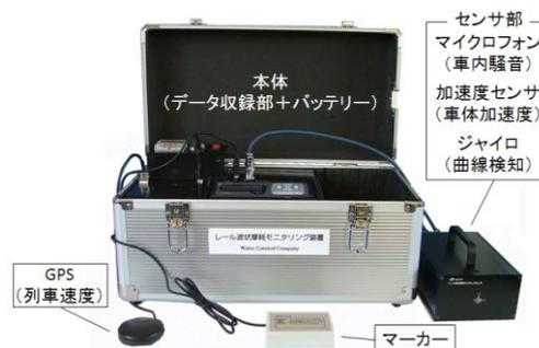
図1 可搬型レール波状摩耗モニタリング装置
