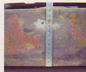
図-4 Ⅲの人工きず (底側部中央5×5×5mm)
