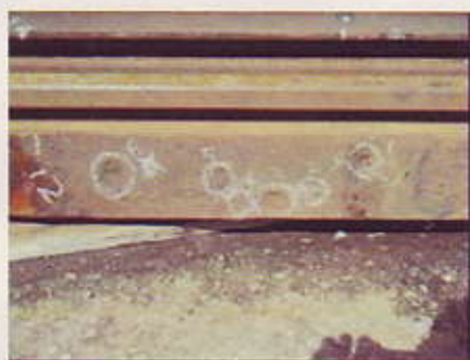
図-7 底部きず全景
