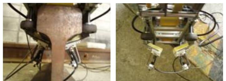
写真-2 新治具によるレール顎下部からの探傷
