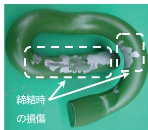
図2 締結後の試験片
