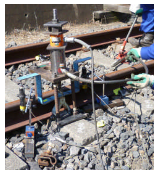
図-8 引抜試験状況
