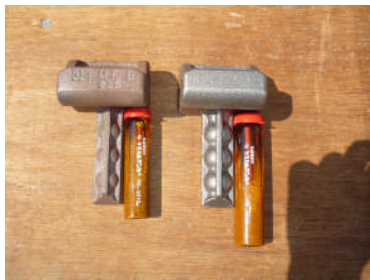
図-2 パンドロールショルダーとせん孔後、穴内及ケミカルアンカーカプセル
