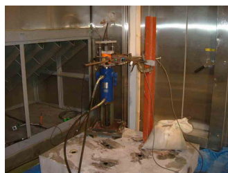
図-3 引抜き試験状況
