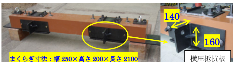
図2 自動沈下補正まくらぎ概観 (単位:mm)
