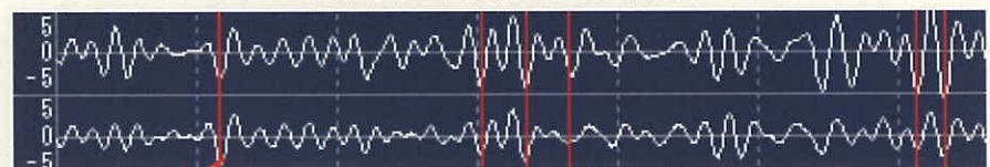
図6 5m 高低狂いと流れ箇所
