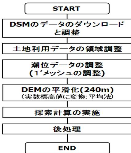
図-2 水没域推定計算の流れ
