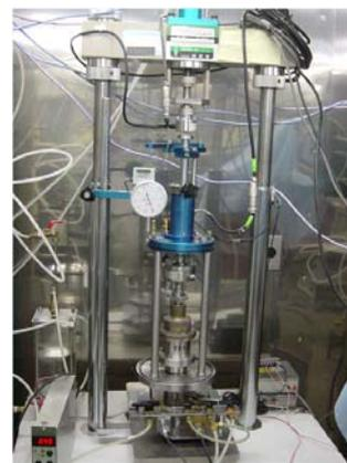
写真-2 拘束圧下の水分特性曲線測定装置
